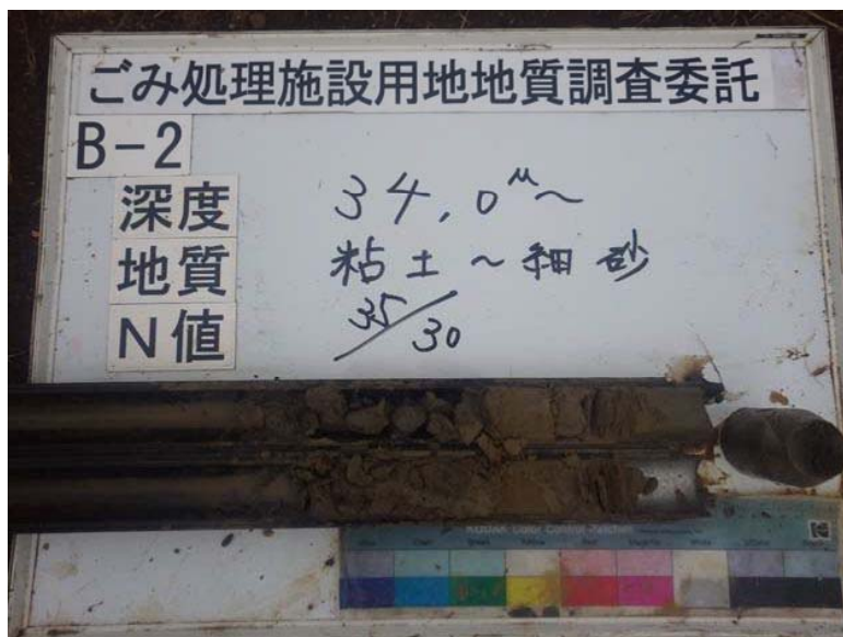
B-2 標準貫入試験試料
