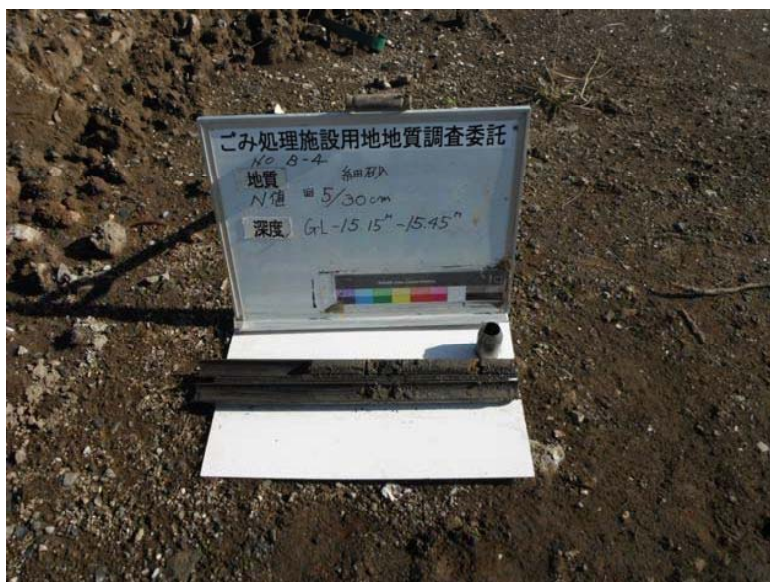
B-4 標準貫入試験試料
