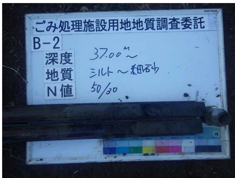
B-2 標準貫入試験試料
