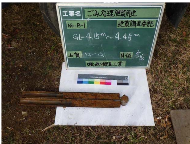
B-1 標準貫入試験試料
