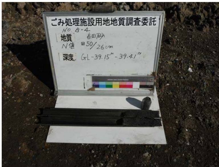
B-4 標準貫入試験試料
