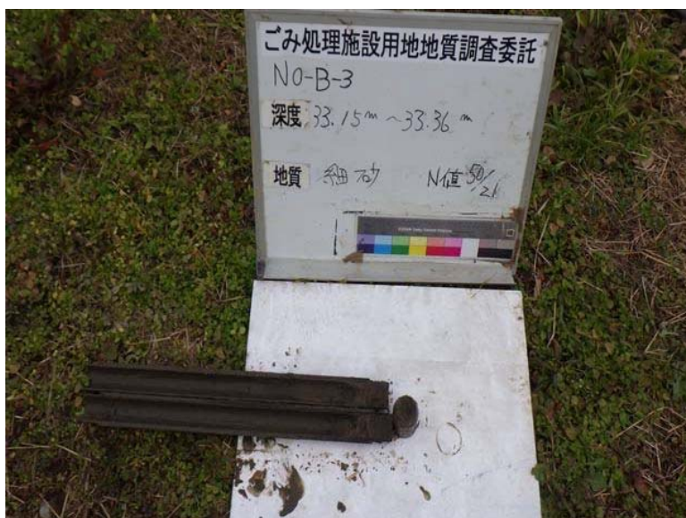
B-3 標準貫入試験試料
