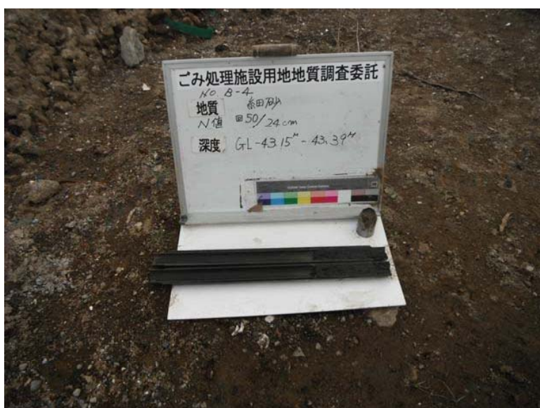
B-4 標準貫入試験試料
