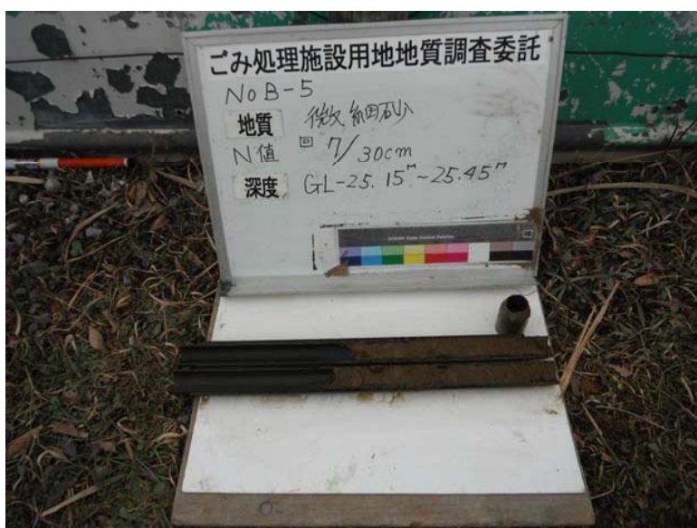
B-5 標準貫入試験試料
