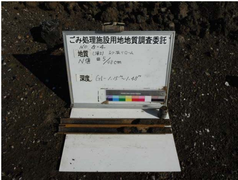
B-4 標準貫入試験試料
