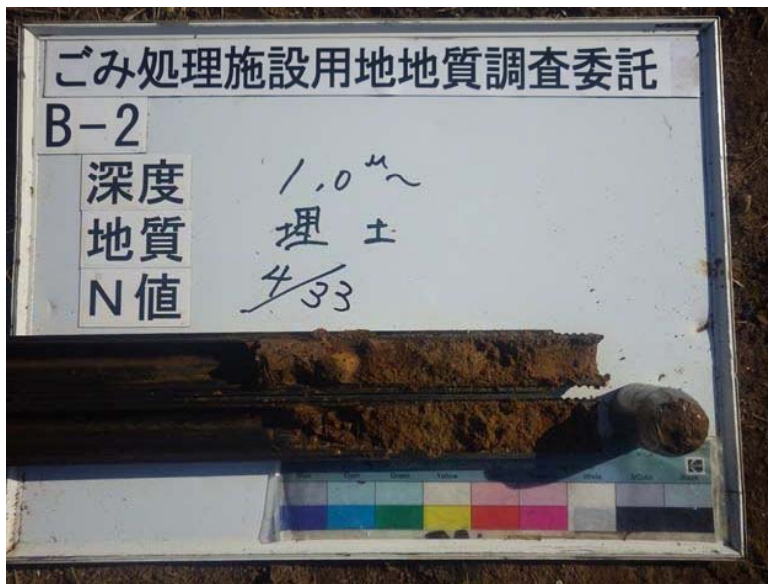
B-2 標準貫入試験試料
