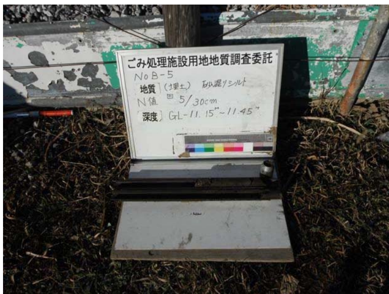
B-5 標準貫入試験試料
