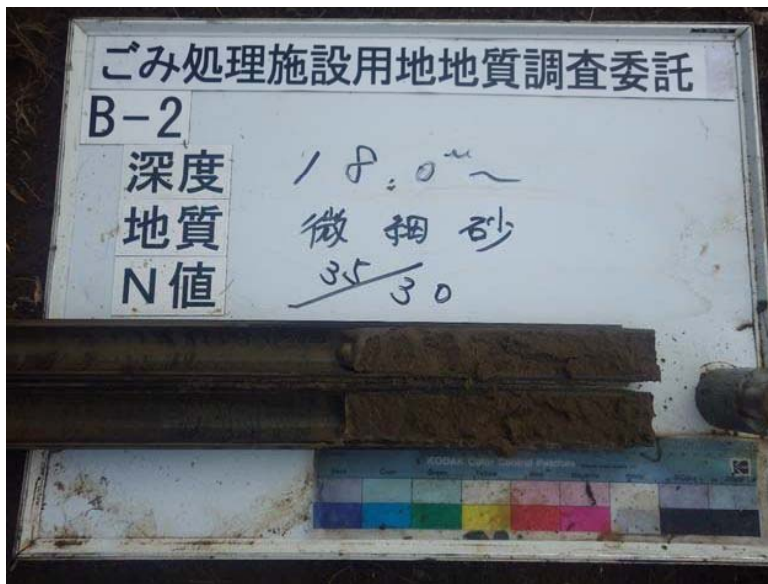
B-2 標準貫入試験試料
