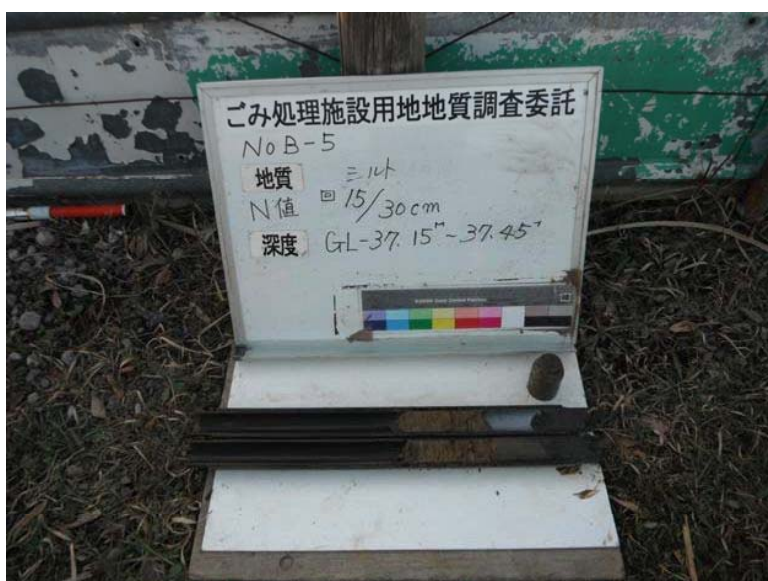
B-5 標準貫入試験試料
