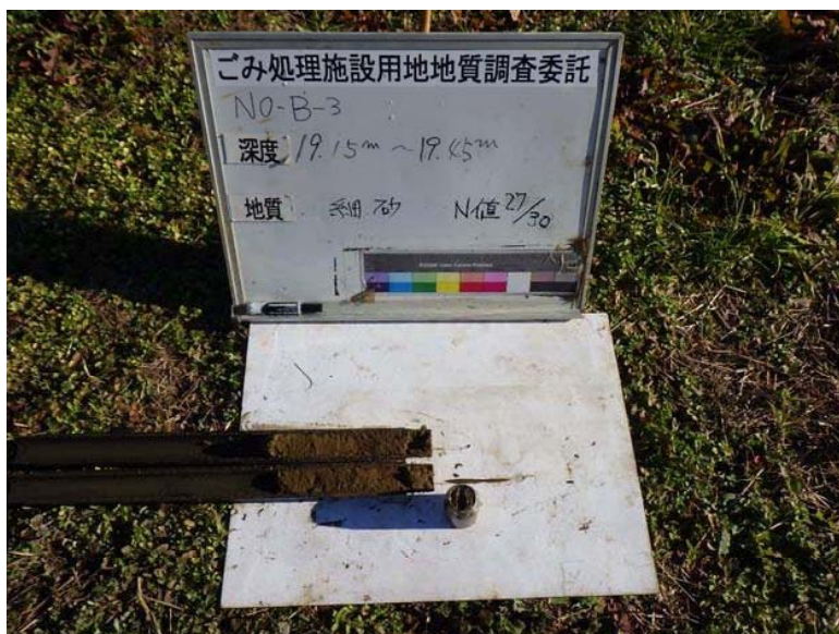
B-3 標準貫入試験試料
