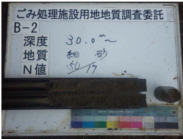
B-2 標準貫入試験試料
