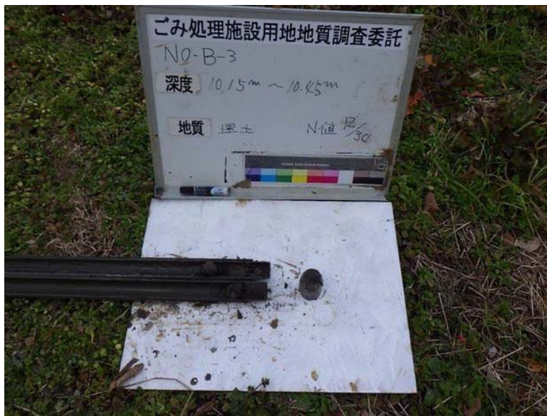
B-3 標準貫入試験試料
