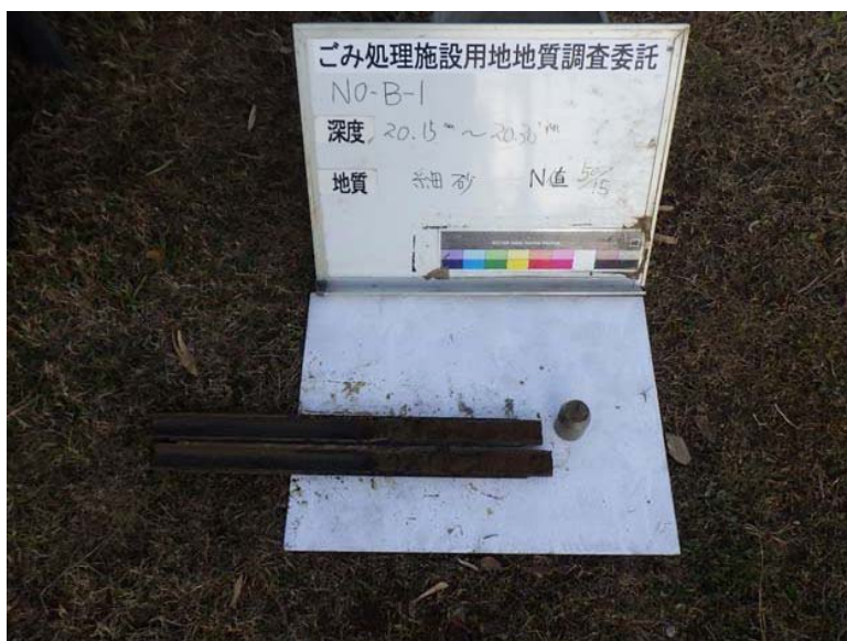
B-1 標準貫入試験試料
