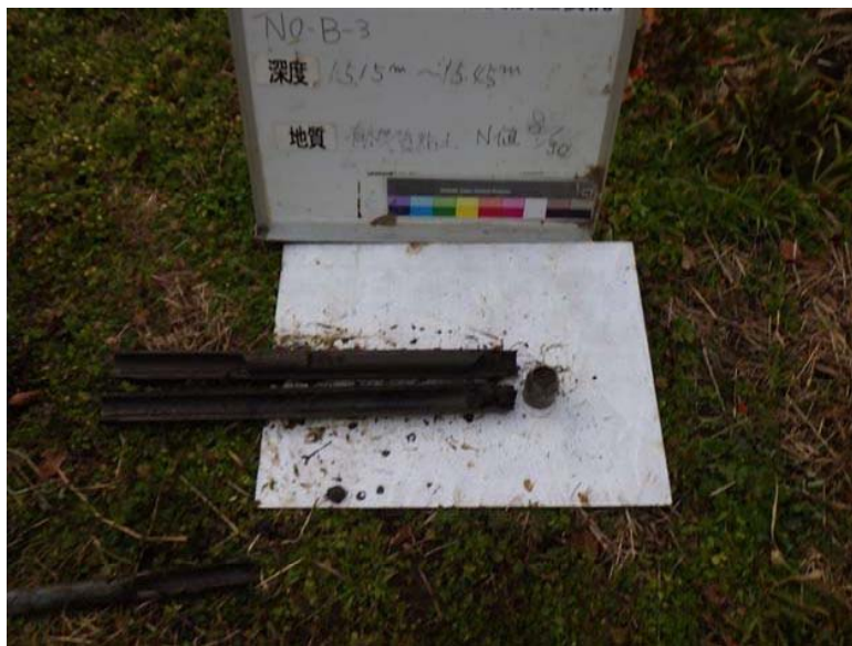
B-3 標準貫入試験試料
